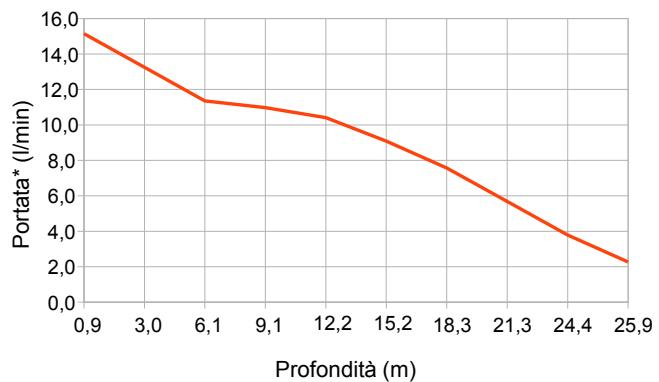
La pompa in Plastica a 12 V **Super Twister® 25 m** è in grado di pompare acqua fino a 25 m di altezza (prevalenza massima) con una semplice batteria da 12 volt. Il suo design è progettato per facilitarne l'utilizzo per tutte le attività di spurgo o campionamento
